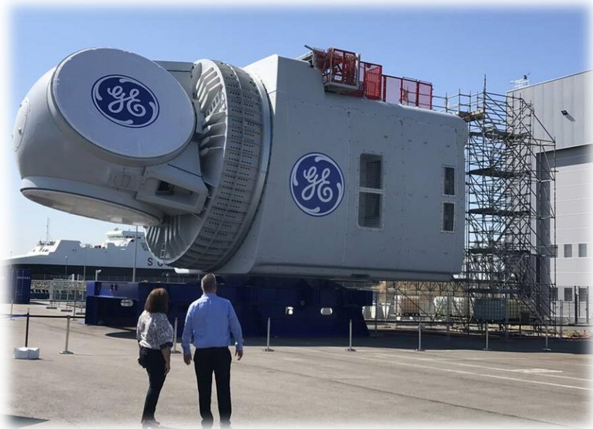
GE Haliade X 12 MW (2021) Nacelle à Montoir : 21 x 10 m 700t
