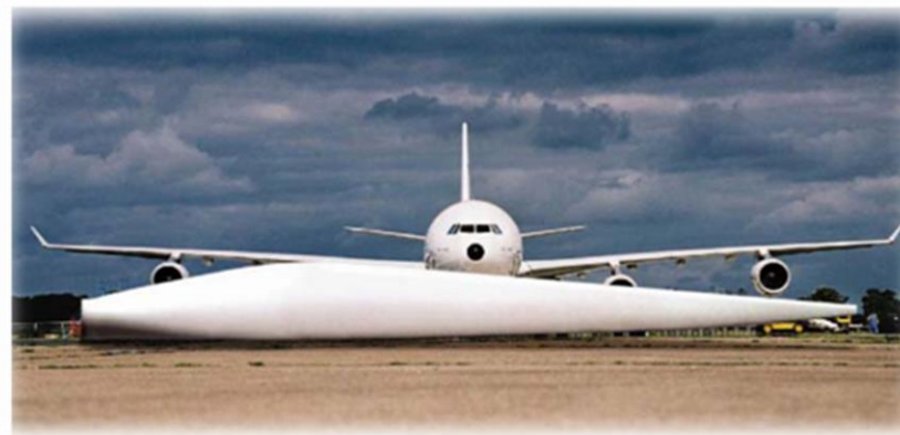
Éolienne 5 mégawatts : 170 mètres
